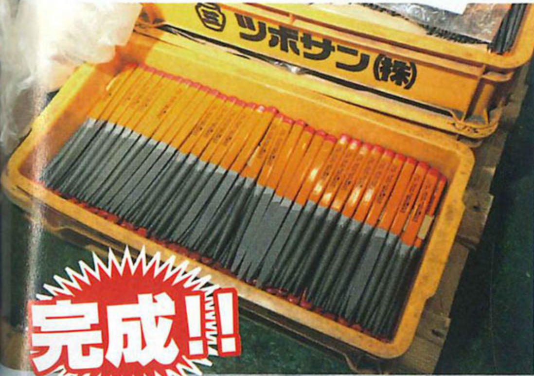
最終検査ではJIS規格で決められたロックウェル硬さHRC56の試験棒で叩いたり、擦ったりしてヤスリの仕上がりを調べる。焼入れすぎていると叩いた際に折れたりし、焼入れが甘いと擦っても引っかかりが甘かったりする。手際よくおこなわれていたけど、これも経験が無いとできない職人ワザだ。ツボサンでは1本1本全部(!!)を試験している。冒頭のことを繰り返すけど、生産本数は月間で20万本
