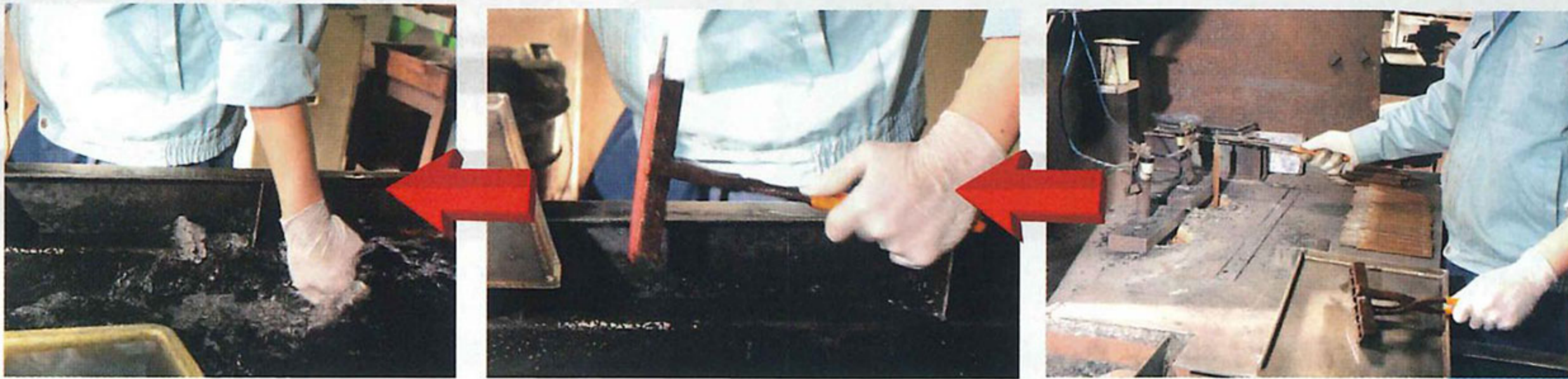
味噌付け後に乾燥させたヤスリは熱した鉛の中に所定時間浸し、その後、水で急速に冷却する焼入れをおこなう。スピードも大事な工程なだけに、真っ赤になったヤスリは釜から取り出されると見事な手さばきで水に浸されていた。左手で持っているペンチは結構な重さがあるため、まさに重労働。大型のヤスリはロボットアームが同様の作業をおこなっていた
