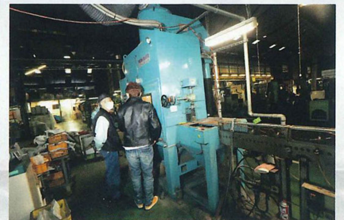
焼入れ後のヤスリはベルトコンベアに載せられ、表面状態を整えるためのサンドブラストマシンに入っていく。サンドブラスト後は防錆油に浸し、その後、切れ味・硬度・歪みなどを見る最終検査場へと運ばれていく
