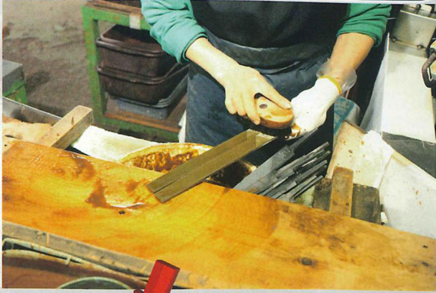
水で溶いた味噌をブラシでヤスリに塗っていく。仕上げに味噌を付けるのは、この後おこなう焼き入れ工程での溶けた鉛が表面に残るのを防ぎ、また味噌の塩分が冷却を助けるため
