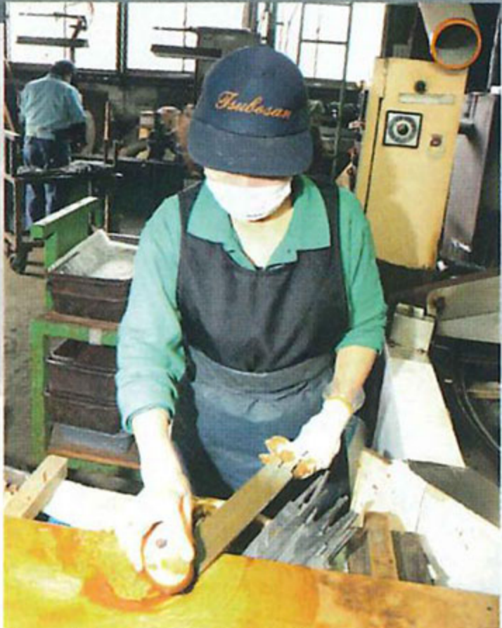
水で溶いた味噌をブラシでヤスリに塗っていく。仕上げに味噌を付けるのは、この後おこなう焼き入れ工程での溶けた鉛が表面に残るのを防ぎ、また味噌の塩分が冷却を助けるため
