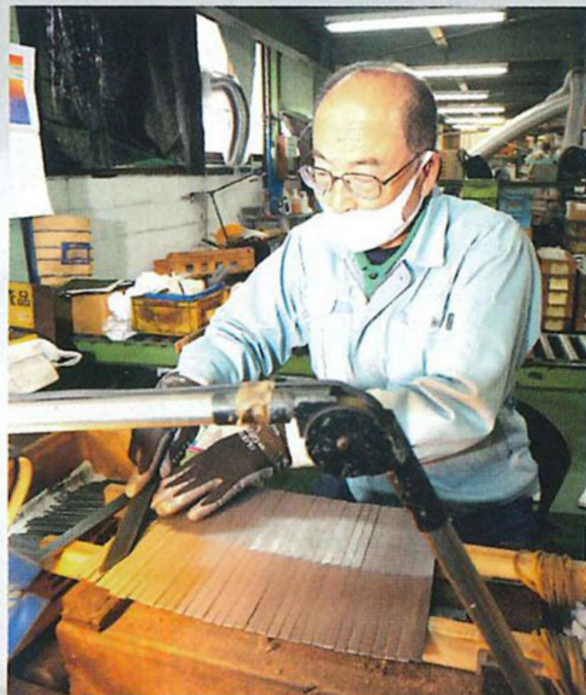
最終検査ではJIS規格で決められたロックウェル硬さHRC56の試験棒で叩いたり、擦ったりしてヤスリの仕上がりを調べる。焼入れすぎていると叩いた際に折れたりし、焼入れが甘いと擦っても引っかかりが甘かったりする。手際よくおこなわれていたけど、これも経験が無いとできない職人ワザだ。ツボサンでは1本1本全部(!!)を試験している。冒頭のことを繰り返すけど、生産本数は月間で20万本
