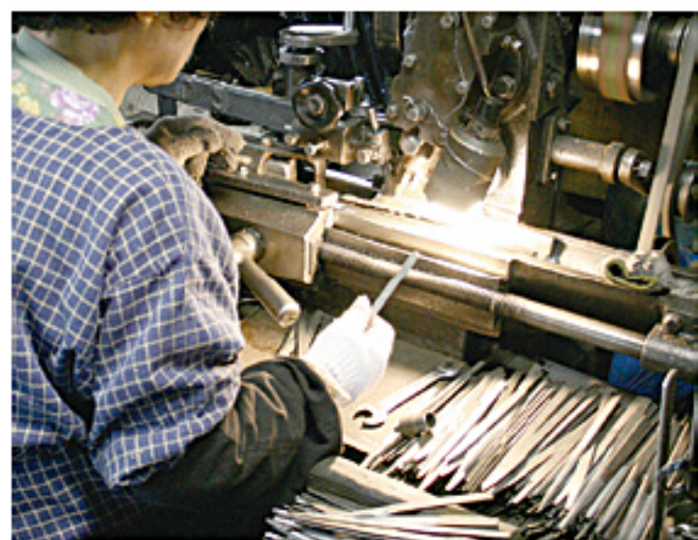
目立て作業。機械で行うが、熟練の技が必要だ
